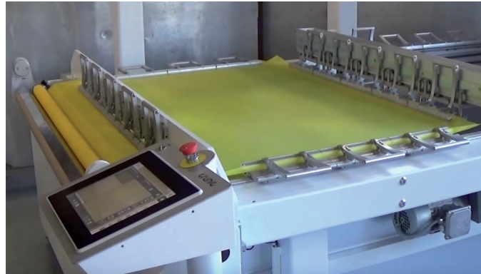
Tratamiento de mallas abiertas de poliéster y de acero
